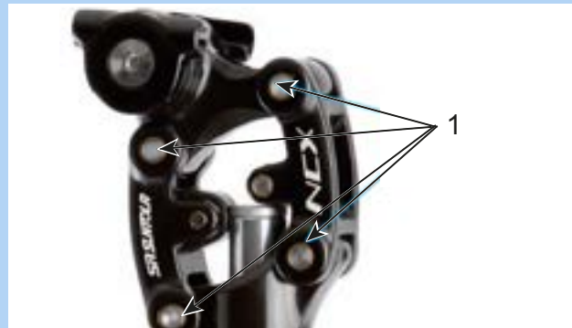
195 paveikslėlis. Spyruoklinio balnelio stovo SR SUNTOUR sutepimas
