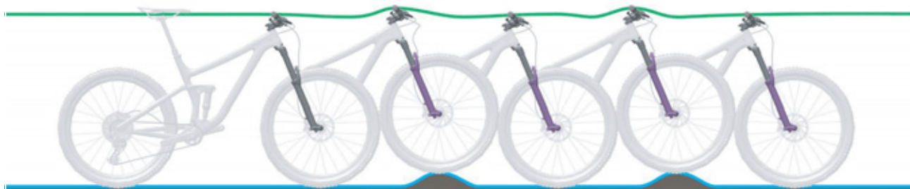
125 paveikslėlis. Optimali šakių važiavimo charakteristika
