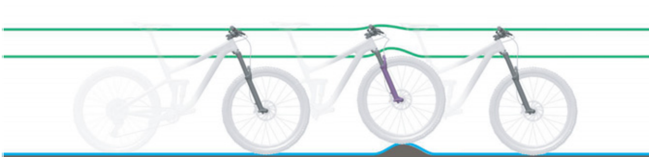
11 paveikslėlis. Optimali šakių važiavimo charakteristika nelygumuose
