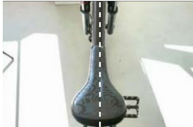
99 paveikslėlis. Sulygiuokite balnelį važiavimo kryptimi
