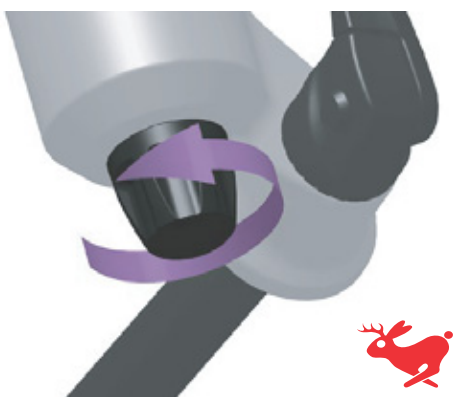
208 paveikslėlis. Pasukite atšokimo pakopos varžtą kiškio kryptimi
