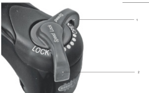
Rysunek 197: Ustawienie nastawnika dobiecia na twardszy tryb pracy
