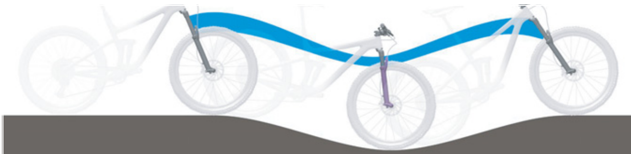
Rysunek 196: Zbyt miękkie amortyzowanie widelca na wzniesieniu
