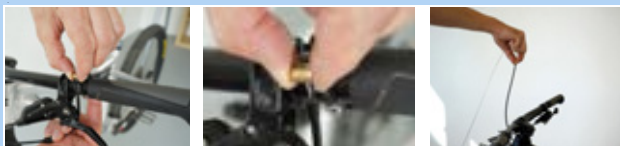
Rysunek 169: Odkręcanie zdalnego sterowania
