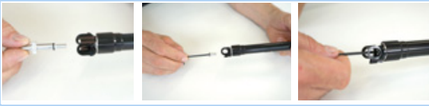
Rysunek 149: Mocowanie nakrętki zaworu wkładu
