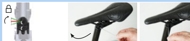
Rysunek 167: Zamykanie mechanizmu regulacji wysokości
