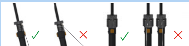
Rysunek 157: Prawidłowa i nieprawidłowa pozycja cięgna Bowdena
