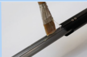
Rysunek 184: Nakładanie smaru
