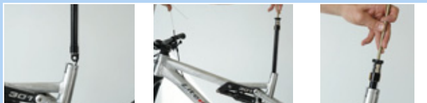
Rysunek 158: Mocowanie nakrętki zaworu wkładu
