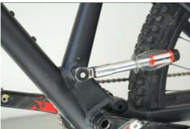
Rysunek 58: Dociąganie osi sztycy podsiodłowej
