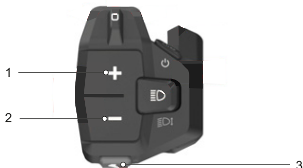
Rysunek 104: Położenie przycisków Plus (1), Minus (2), i mechanizmu wspomagającego pchanie (3)
