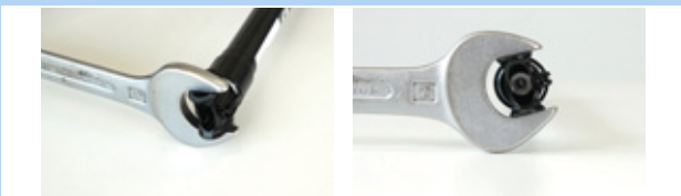
Rysunek 151: Zabezpieczenie przed przekręceniem się
