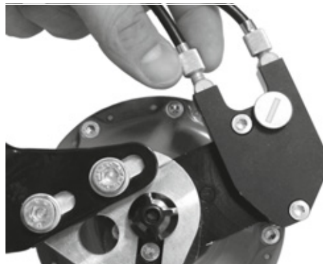
Rysunek 123: Wersje piast Rohloff z zewnętrznym sterowaniem zmiany biegów mają regulator linki na przepustnicy kablowej, która znajduje się po lewej stronie
