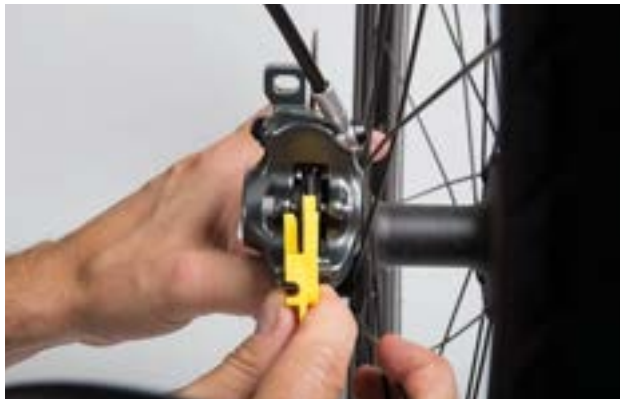
Rysunek 119: Sprawdzenie stanu klocków hamulca w stanie zamontowanym za pomocą zabezpieczenia transportowego
