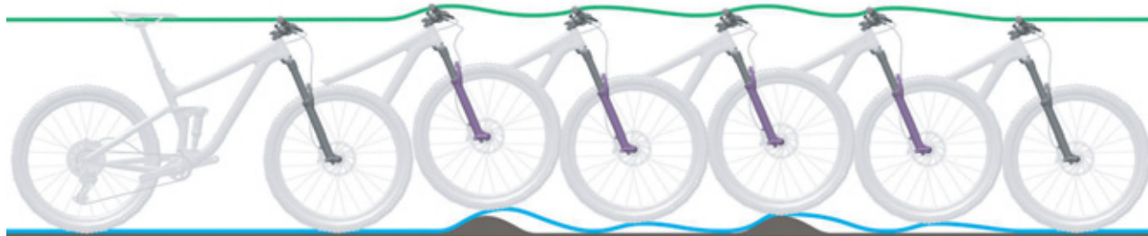
Rysunek 192: Zbyt szybkie rozprężanie widelca amortyzowanego
