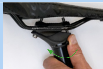
Rysunek 186: Zamykanie mechanizmu regulacji wysokości
