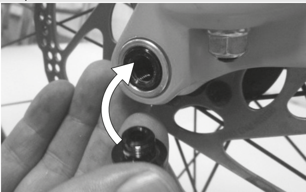
Figura 26: Applicazione della leva del bloccaggio rapido nel perno
