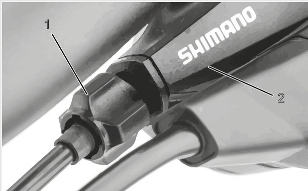
Figura 81: Boccola di regolazione (1) del cambio azionato da cavo singolo con scatola della leva del cambio (2), esempio
