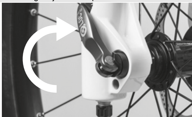
Rysunek 40: Zamykanie zacisku szybko mocującego
