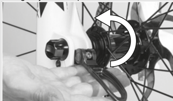
Rysunek 34: Sposób zabezpieczania dźwigni
