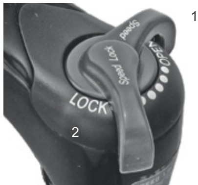
Rysunek 76: Nastawnik dobicia Suntour z pozycjami OPEN (1) i LOCK (2)
