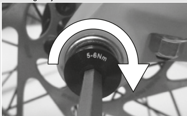
Rysunek 28: Sposób dokręcania śruby zabezpieczającej
