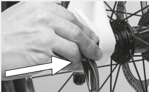
Rysunek 38: Wsuwanie zacisku szybko mocującego
