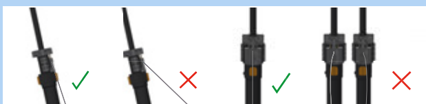
Rysunek 199: Prawidłowa i nieprawidłowa pozycja cięgna Bowdena
