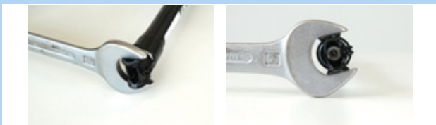
Rysunek 193: Zabezpieczenie przed przekręceniem się
