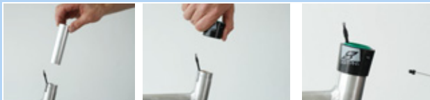
Rysunek 229: Montaż tulei ślizgowej i tulei zewnętrznej
