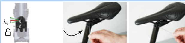
Rysunek 172: Ustawianie mechanizmu regulacji wysokości w pozycji „otwartej”.
