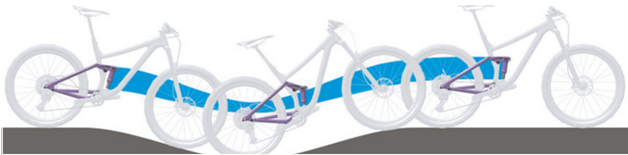
Rysunek 246: Zbyt miękkie amortyzowanie tylnego amortyzatora na wzniesieniu
