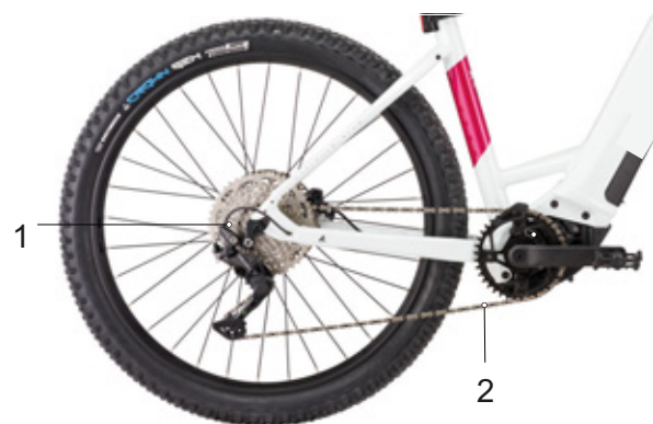
Rysunek 36: Schemat napędu łańcuchowego z przerezutką
