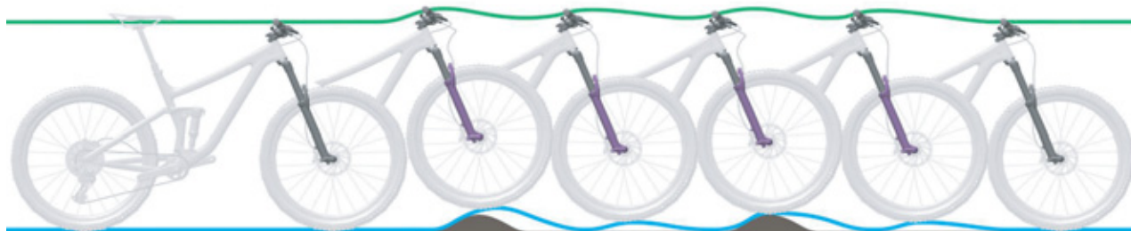
Rysunek 234: Zbyt szybkie rozprężanie widelca amortyzowanego
