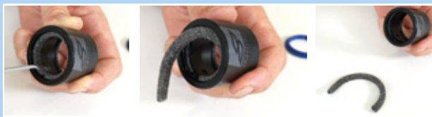
Rysunek 183: Wyciąganie pierścienia filcowego
