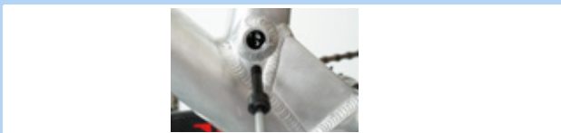
Rysunek 175: Odkręcanie osi sworznia
