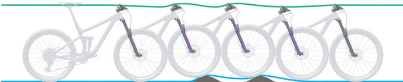
Rysunek 236: Zbyt wolne rozprężanie widelca amortyzowanego
