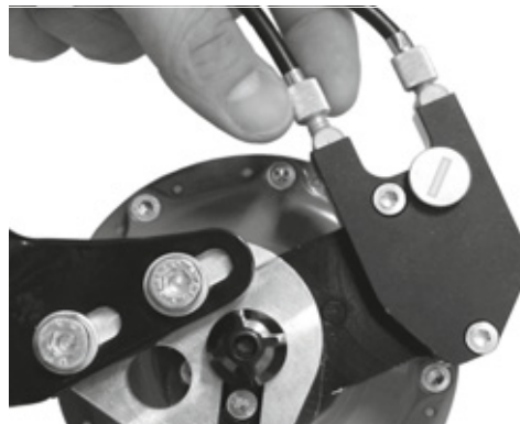
Rysunek 165: Wersje piast Rohloff z zewnętrznym sterowaniem zmiany biegów mają regulator linki na przepustnicy kablowej, która znajduje się po lewej stronie
