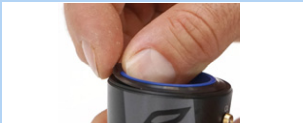
Rysunek 215: Ściąganie wargowego pierścienia uszczelniającego
