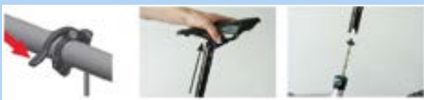
Rysunek 173: Wyciąganie sztycy podsiodłowej
