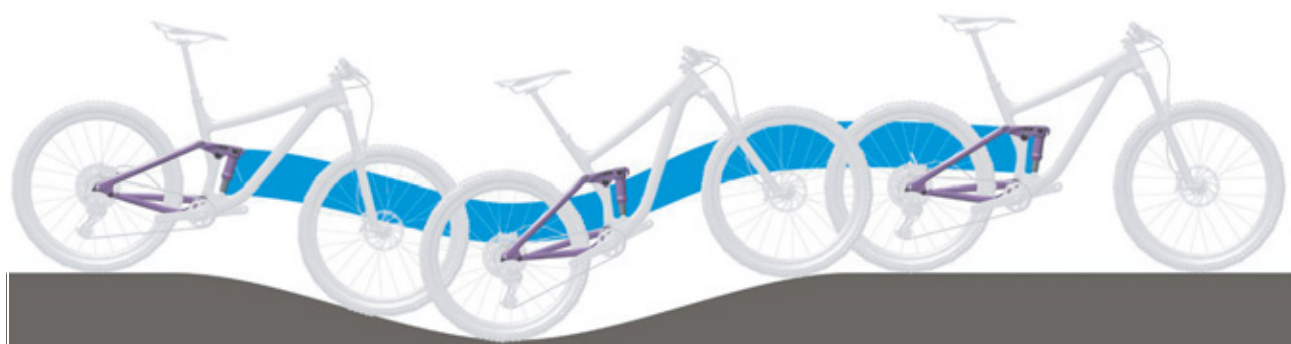
Rysunek 20: Optymalne działanie tylnego amortyzatora na pagórkowatym terenie
