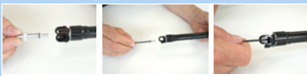
Rysunek 191: Mocowanie nakrętki zaworu wkładu
