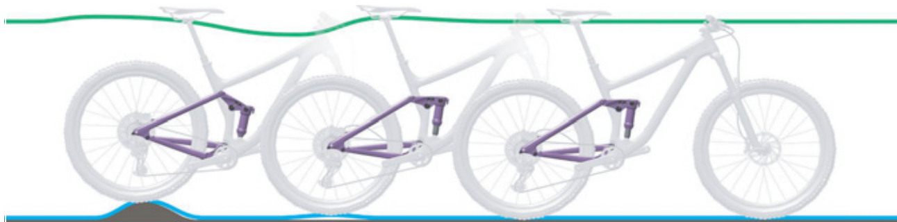
Rysunek 242: Zbyt szybkie rozprężanie się tylnego amortyzatora
