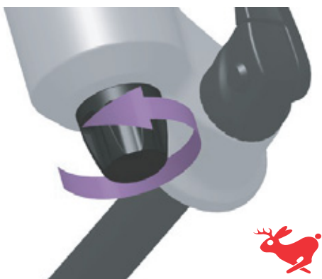
Rysunek 237: Obrócić pokrętko nastawnika odbicia w kierunku symbolu zająca
