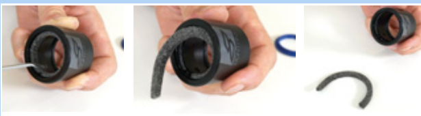
Rysunek 218: Wyciąganie pierścienia filcowego
