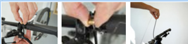
Rysunek 211: Odkręcanie zdalnego sterowania
