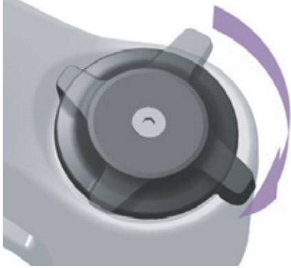
Rysunek 149: Ustawienie nastawnika dobiecia na twardszy tryb pracy
