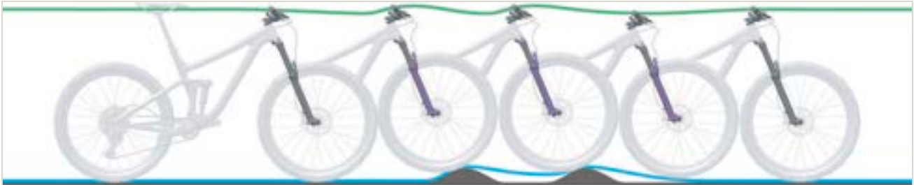
Figur 248: Fjedergaflen fjedrer for langsomt tilbage
