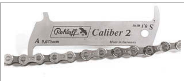
Figur 205: Eksempel på målelære fra ROHLOFF
