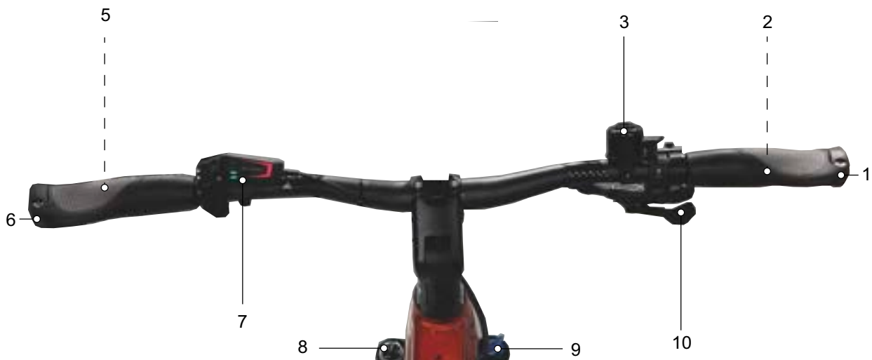
Figur 53: Detaljeret visning af styr med BOSCH Kiox 300, eksempel
