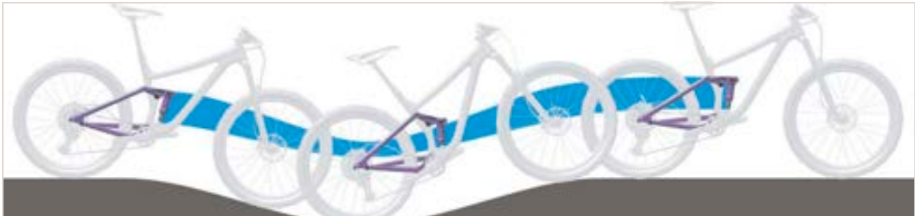
Figur 268: Bagdæmperens affjedring er for blød på bakker
