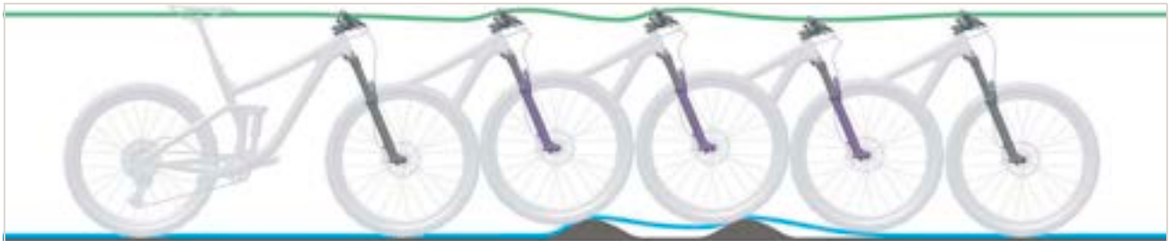
Figur 234: Fjedergaflen fjedrer for langsomt tilbage
