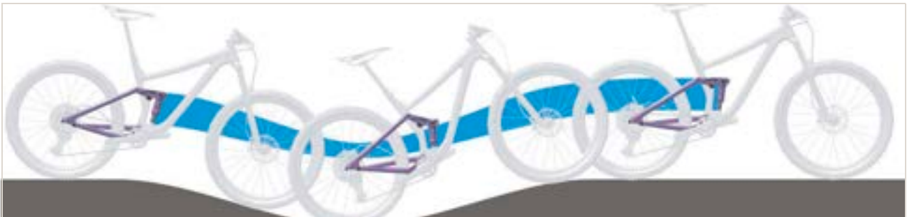
Figur 260: Bagdæmperens affjedring er for blød på bakker
