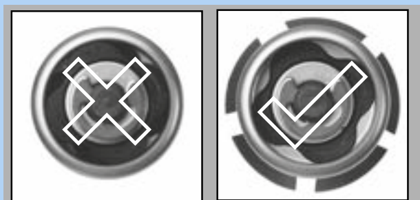
Figur 84: Lukkert og åbnet flange
