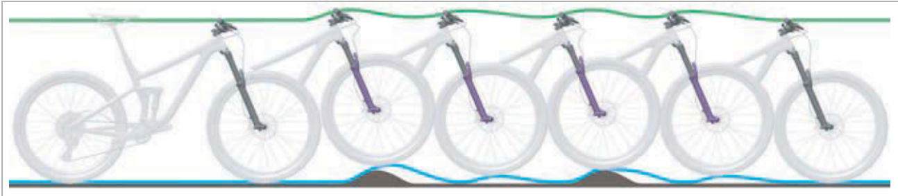
Figur 240: Fjedergaflen fjedrer for hurtigt tilbage
