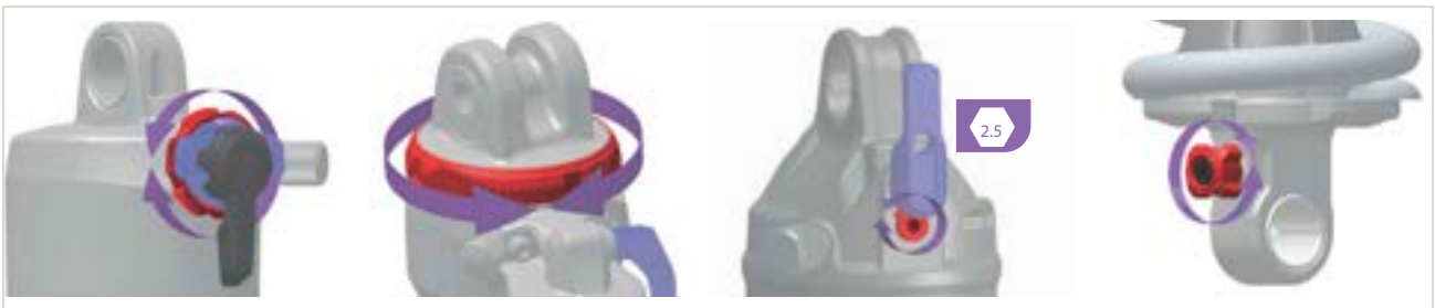
Figur 273: Trækinstillingsanordningens (bagdæmper) (rød) placering og form afhænger af den pågældende model
