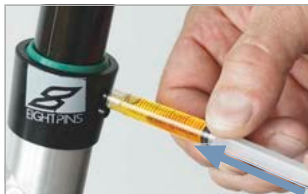
Figur 196: Smøring af EIGHTPINS-sadelpind
