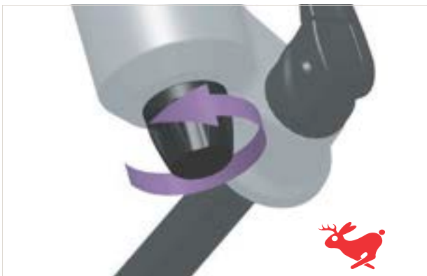
Figur 235: Drej trækindstillingsanordningen (gaffel) hen mod haren
