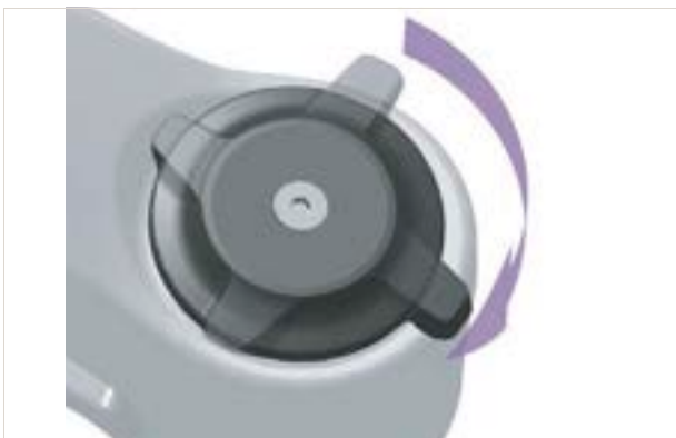
Figur 237: Hårdere indstilling af trykindstillingsanordningen
