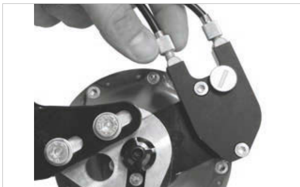
Figur 225: På udgaver af ROHLOFF-nav med ekstern skifteaktivering sidder kabelindstilleren på wireboksen, som sidder på venstre side
