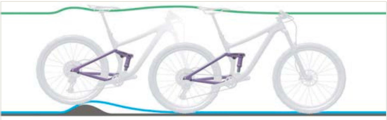
Figur 278: For hård dæmpning på bagdæmperen ved ujævnheder
