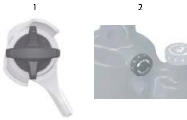
Figur 267: Trækindsstillingsanordning Float DPS (1) og Float X (2)
