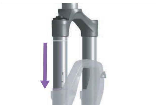
Figur 132: Forskydning af fjedergaflens O-ring
