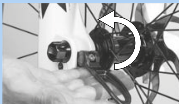
Figur 81: Hurtigbespændingen trykkes i pilens retning
