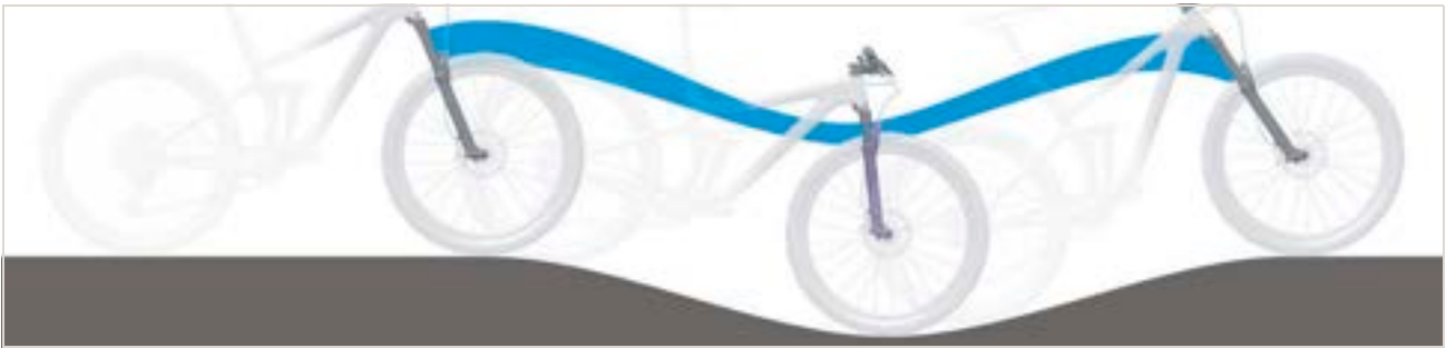
Figur 250: Fjedergaflens affjedring er for blød på bakker
