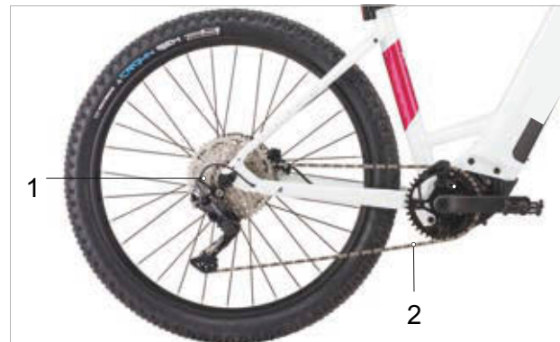
Figur 45: Oversigt over kædedrev med kædegearskit
