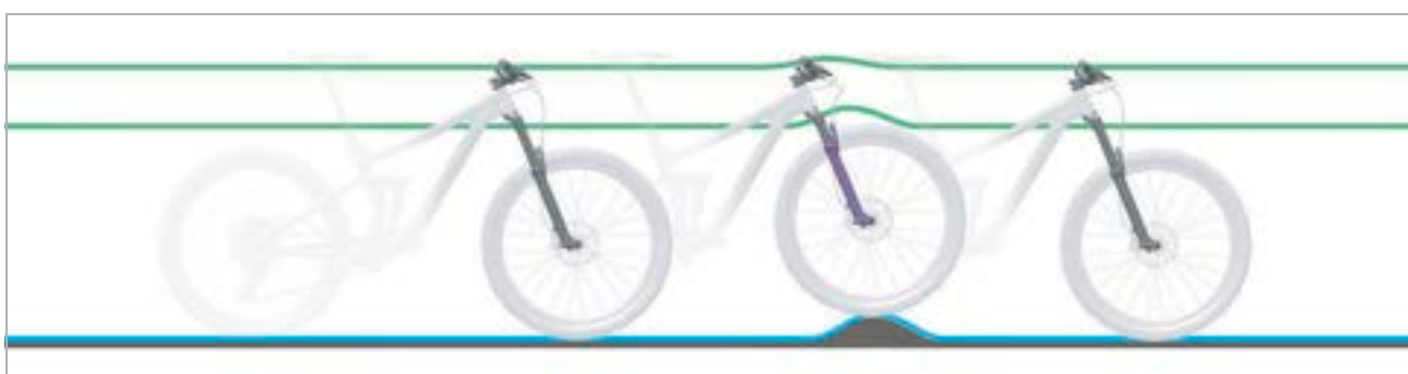
Figur 168: Hårdt og blødt indstillet trykdæmper
