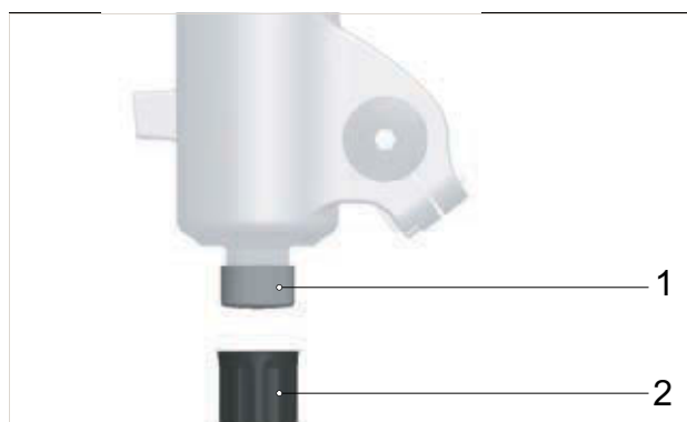
Figur 150: FOX-trækindsstillingsanordning (gaffel) (1) under gaffelkappe (2)
