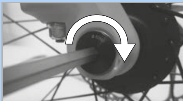
Figur 75: Fastspænd akslen i pilens retning
