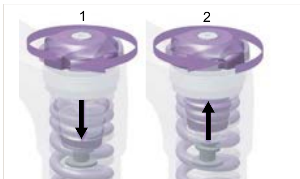
Figur 131: Drej indstillingshjulet for SAG ind (1) og ud (2)
