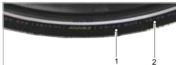
Figur 197: Oplysninger om dæktryk i bar (1) og psi (2)
