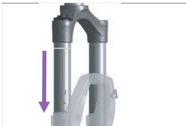
Figur 135: Forskyd O-ringen på fjedergaflen
