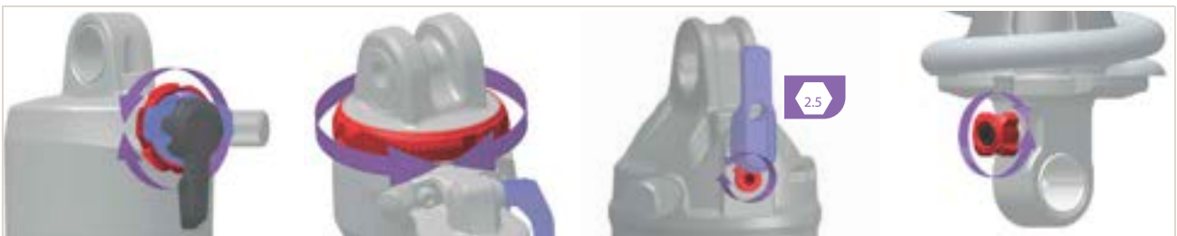
Figur 275: Trækinstillingsanordningens (rød) placering og form afhænger af den pågældende model
