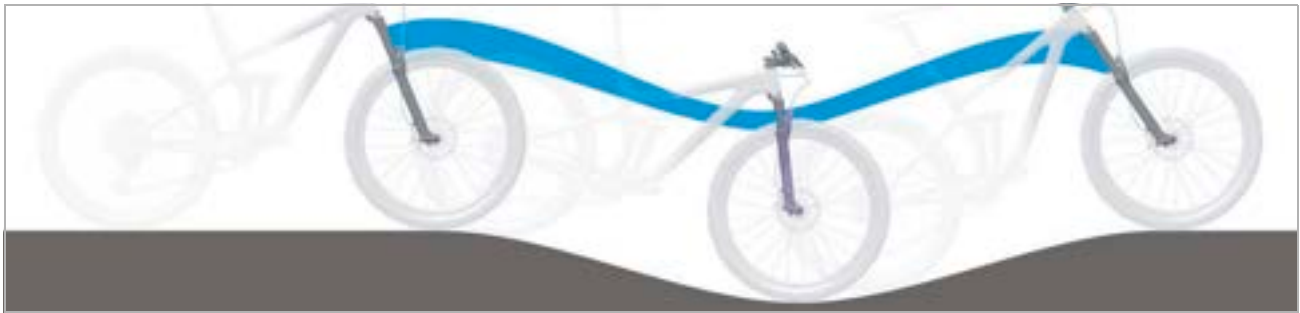
Figur 244: Fjedergaflens affjedring er for blød på bakker
