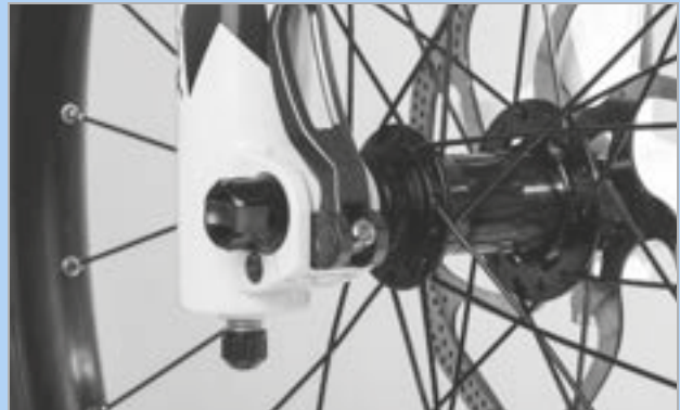
Figur 228: Indstilling af hurtigbespændingens spændekraft
