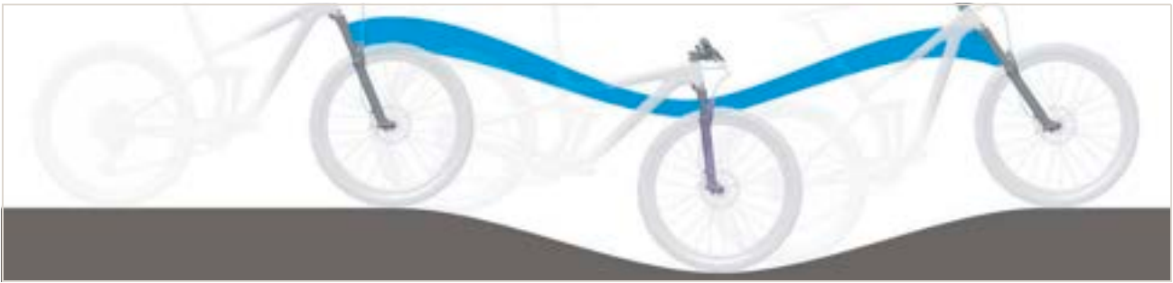
Figur 236: Fjedergaflens affjedring er for blød på bakker
