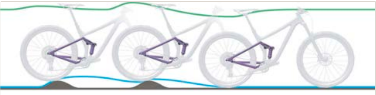
Figur 266: For langsom tilbagefjedring på bagdæmperen
