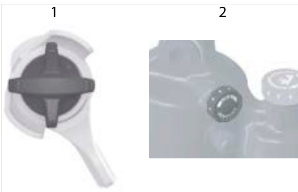
Figur 265: Trækindsstillingsanordning Float DPS (1) og Float X (2)
