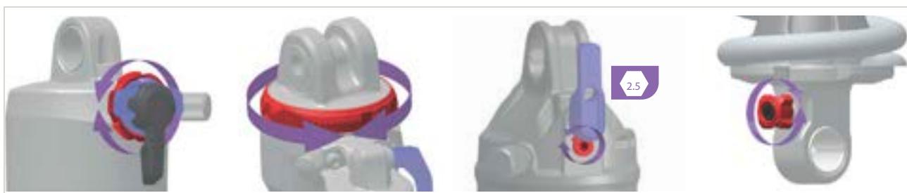
Figur 153: Trækindstillingsanordningens placering og form (bagdæmper) (rød) afhænger af modellen
