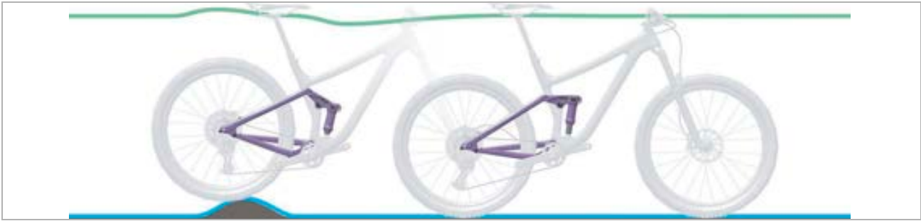
Figur 7: Bagdæmperen fungerer optimalt ved ujævnheder
