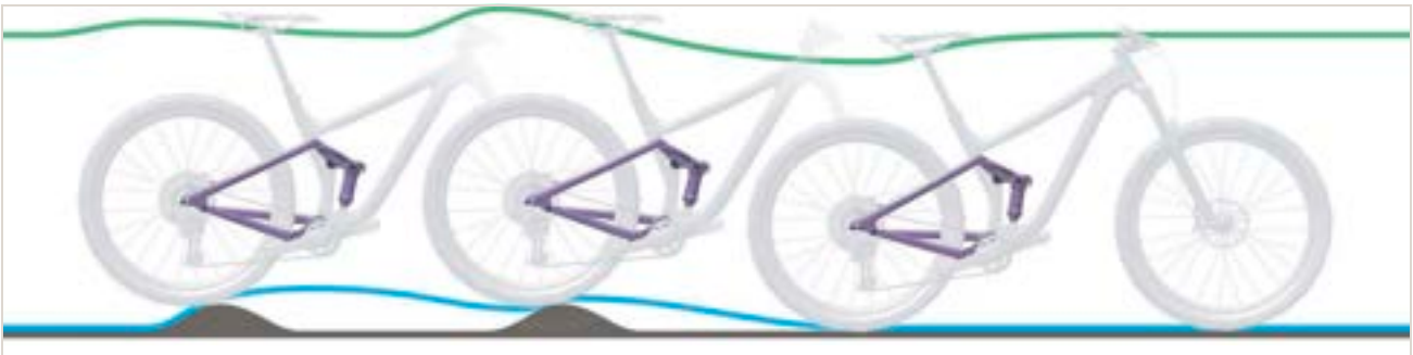
Figur 274: For langsom tilbagefjedring på bagdæmperen
