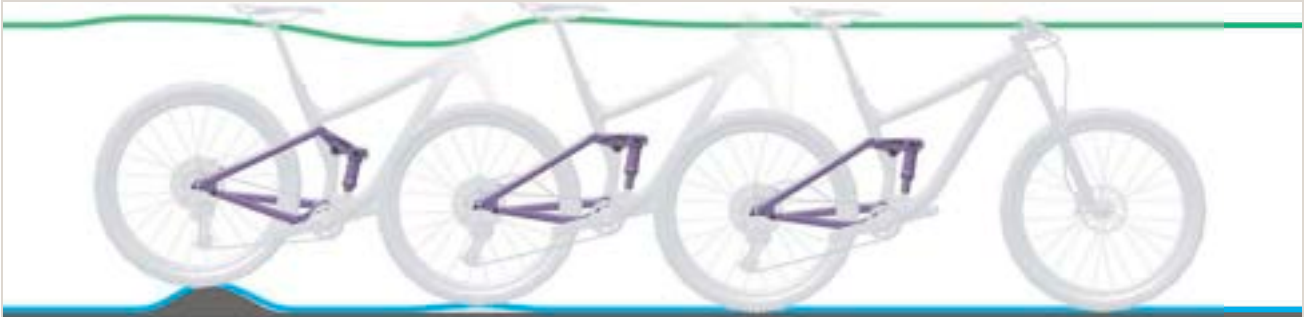
Figur 272: For hurtig tilbagefjedring på bagdæmperen
