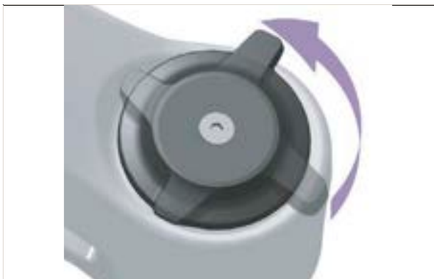
Figur 239: Blødere indstilling af tryktrinsindstillingsanordningen
