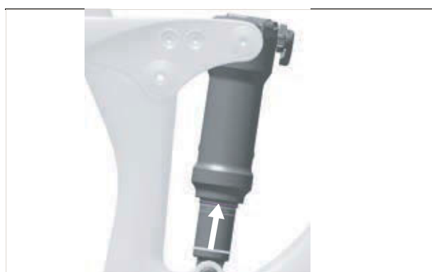
Figur 144: Forskyd O-ringen på bagdæmperen
