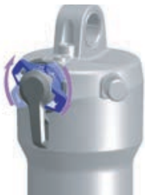
Abbildung 65: Druckstufeneinsteller härter einstellen
