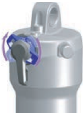
Abbildung 112: Druckstufeneinsteller härter einstellen
