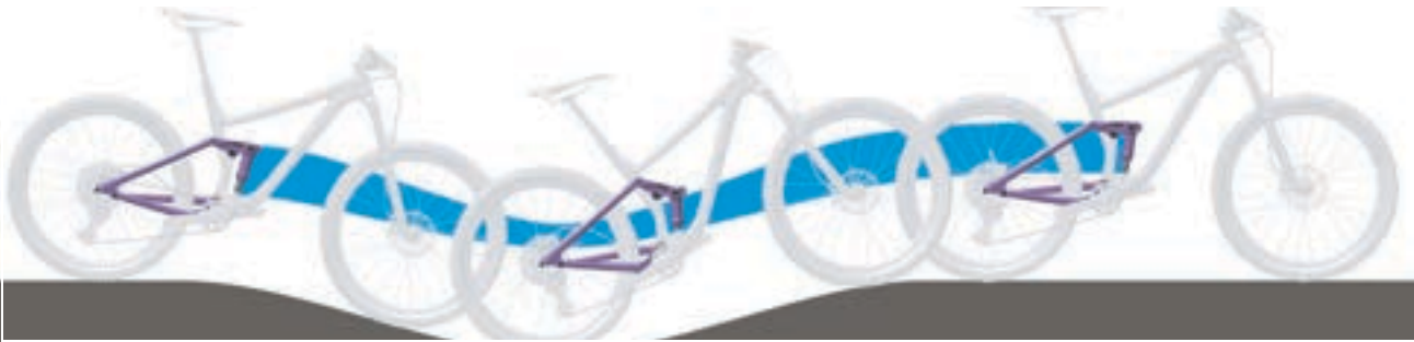
Abbildung 111: Zu weiche Federung des Hintebau-Dämpfers am Berg
