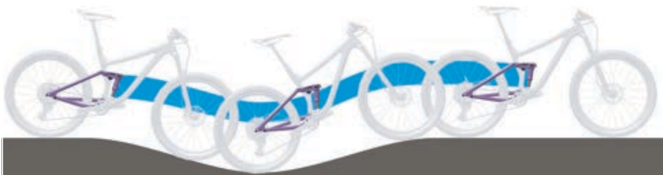
Abbildung 11: Optimales Fahrverhalten des Hinterbau-Dämpfers im hügeligen Gelände
