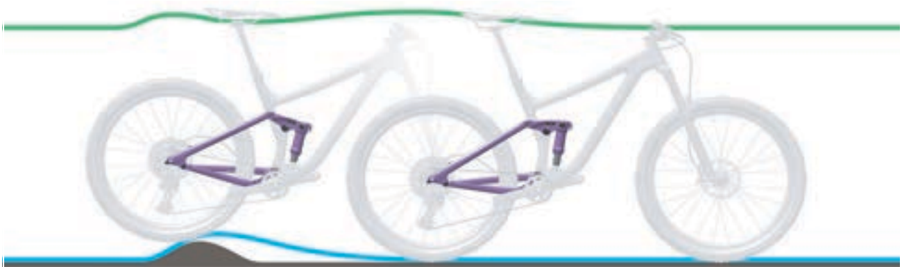
Abbildung 113: Zu harte Dämpfung des Hinterbau-Dämpfers bei Unebenheiten
