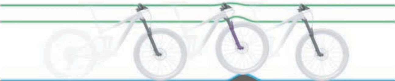
Abbildung 7: Optimales Fahrverhalten der Gabel bei Unebenheiten
