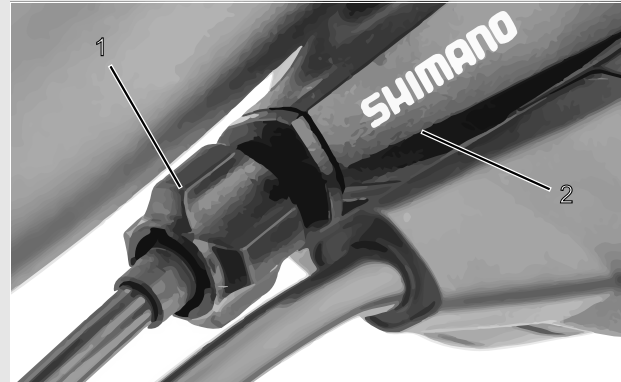
Abbildung 116: Einstellhülse (1) der einzügigen, seilzugbetätigten Gangschaltung mit Schalthebelgehäuse (2), Beispiel
