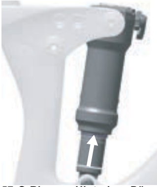
Abbildung 57: O-Ring am Hinterbau-Dämpfer verschreiben
