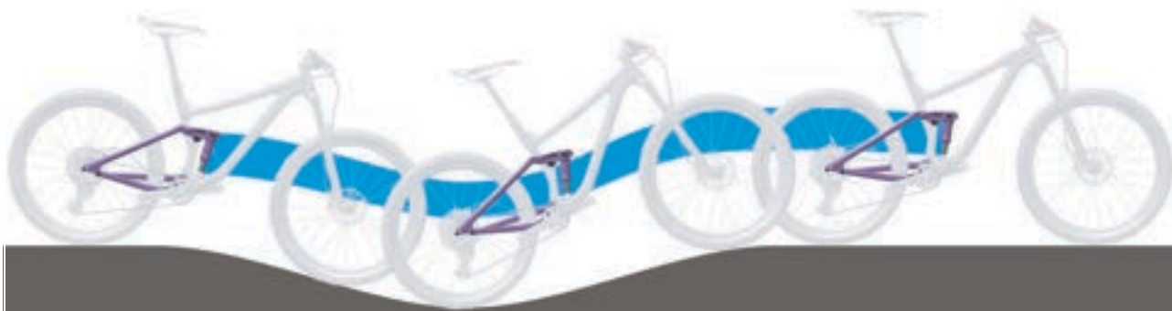
Abbildung 63: Optimales Fahrverhalten des Hinterbau-Dämpfers im hügeligen Gelände
