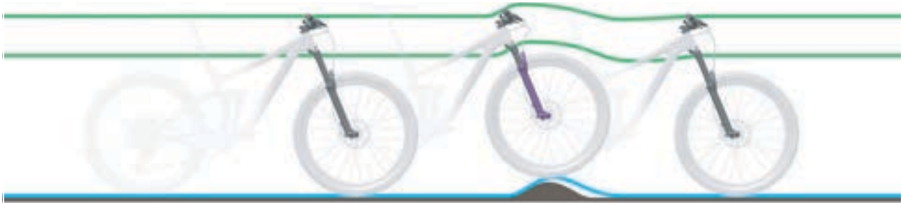
Abbildung 105: Zu harte Dämpfung der Federgabel bei Unebenheiten
