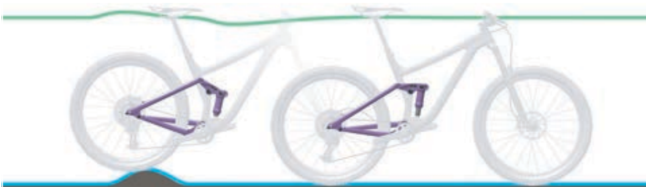
Abbildung 64: Optimales Fahrverhalten des Hinterbau-Dämpfers bei Unebenheiten
