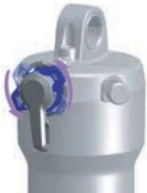
Abbildung 114: Druckstufeneinsteller weicher einstellen
