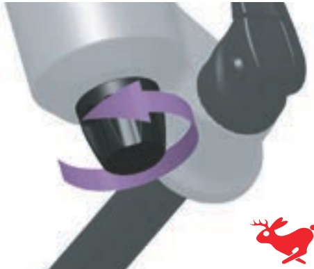
Abbildung 102: Zugstufendämpfer in Richtung Hase drehen
