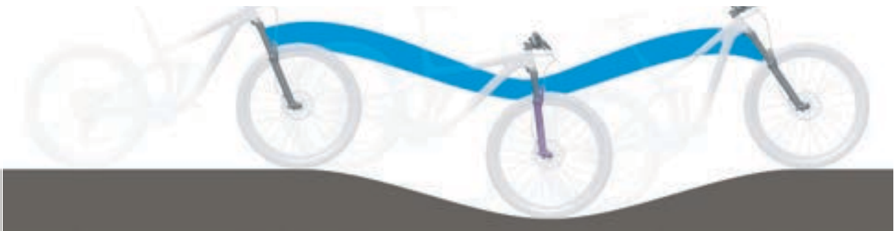
Abbildung 6: Optimales Fahrverhalten der Gabel im hügeligen Gelände
