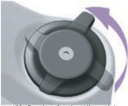
Abbildung 109: Druckstufeneinsteller weicher einstellen
