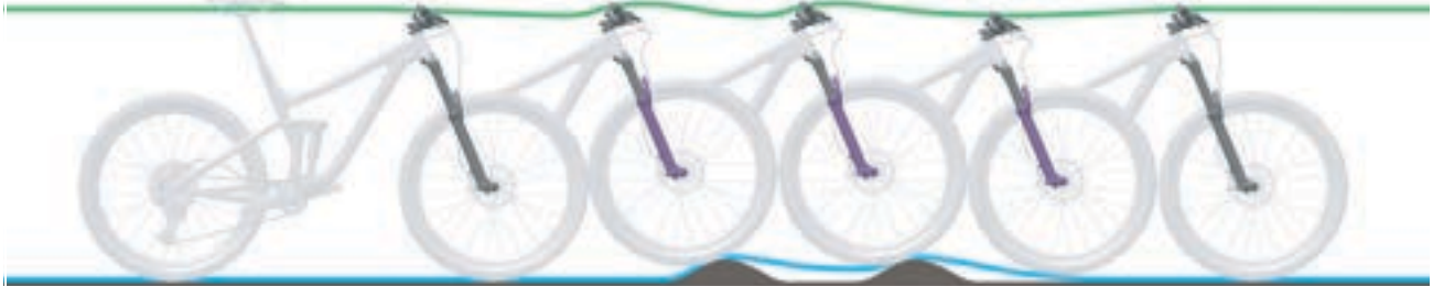
Abbildung 101: Zu langsames Ausfedern der Federgabel
