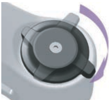
Abbildung 104: Druckstufeneinsteller härter einstellen
