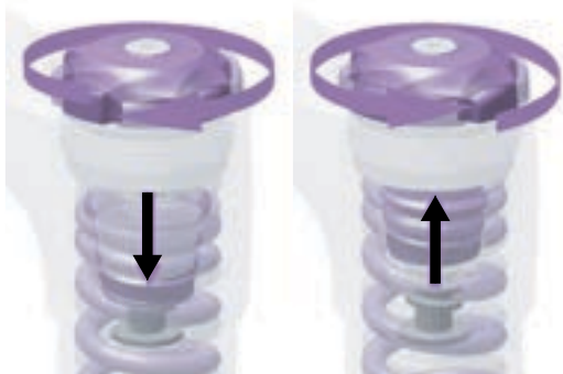
Abbildung 52: Vorspannungseinstellung herein und heraus drehen.
