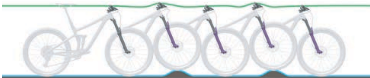
Abbildung 58: Optimales Fahrverhalten der Gabel
