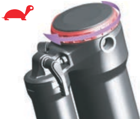
Abbildung 108: Zugstufendämpfer in Richtung Schildkröte drehen
