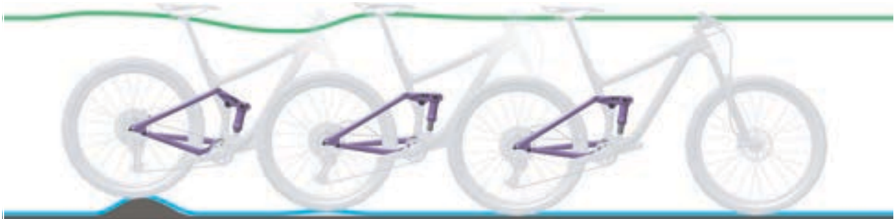
Abbildung 107: Zu schnelles Ausfedern des Hinterbau-Dämpfers
