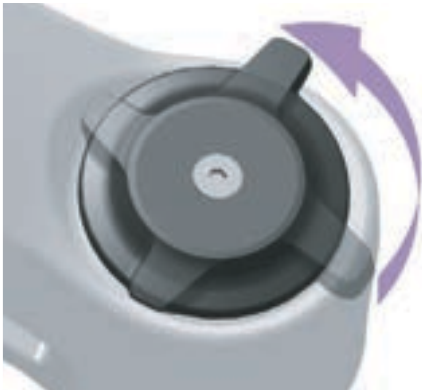
Abbildung 106: Druckstufeneinsteller weicher einstellen
