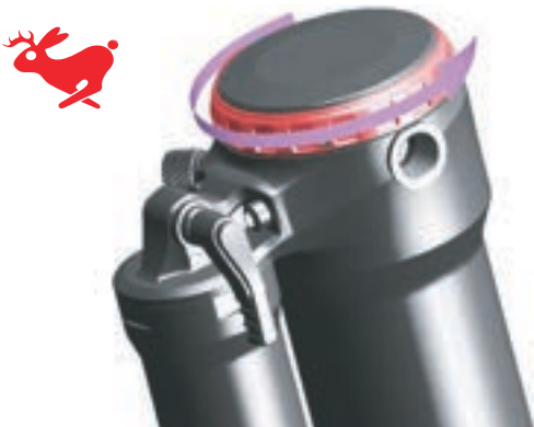
Abbildung 110: Zugstufendämpfer in Richtung Hase drehen
