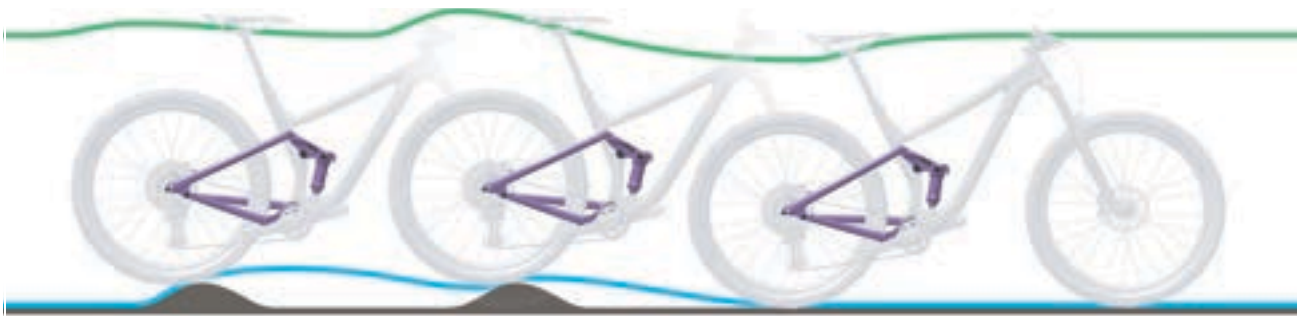
Abbildung 109: Zu langsames Ausfedern des Hinterbau-Dämpfers
