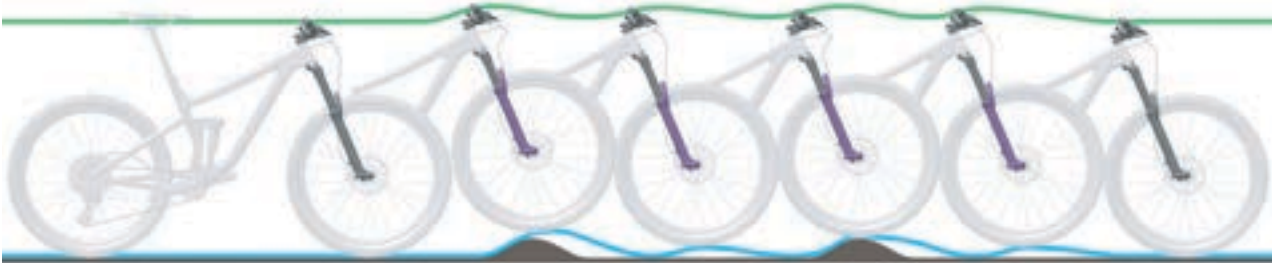
Abbildung 99: Zu schnelles Ausfedern der Federgabel
