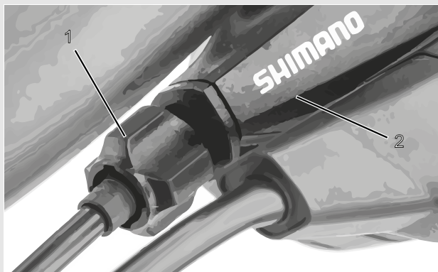
Afbeelding 86: Afstelwartel (1) van de versnelling met enkele bowdenkabelbediening en behuizing van de schakelhendel (2), voorbeeld
