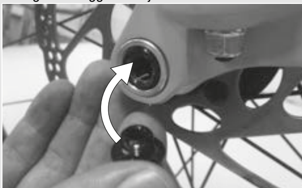
Afbeelding 27: Snelspanhendel in as schuiven
