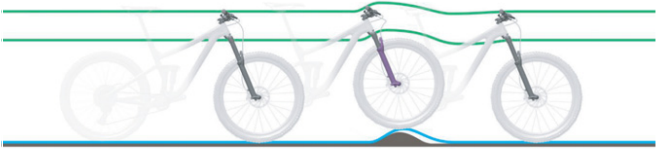
Obr. 95: Příliš tvrdé tlumení odpružené vidlice u nerovnosti
