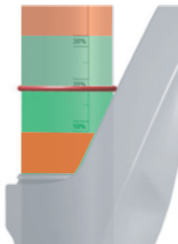
Obr. 58: Předepsaný rozsah SAG (zelený) a zakázaný rozsah SAG
