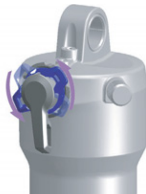
Obr. 72: Měkké nastavení nastavovacího šroubu komprese
