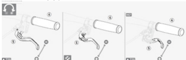
Obr. 51: Nastavení vzdálenosti brzdové páky kotoučové brzdy Magura
