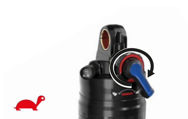
Obr. 66: Snížení rychlosti roztahování
