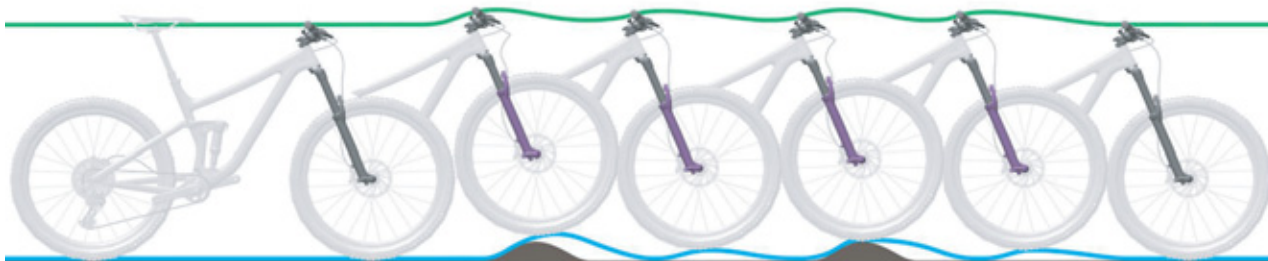
Obr. 89: Příliš rychlé roztahování odpružené vidlice
