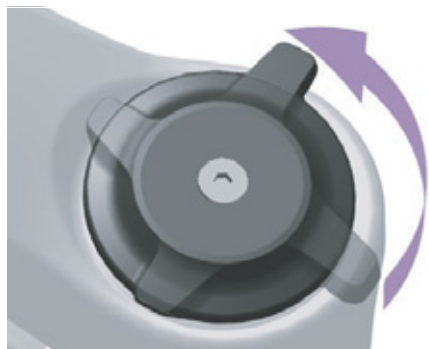
Obr. 79: Měkké nastavení nastavovacího šroubu komprese
