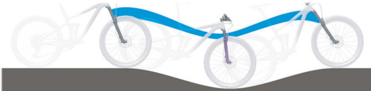
Obr. 93: Příliš měkké odpružení odpružené vidlice v horách
