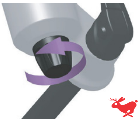
Obr. 92: Otáčení tlumiče zpětného odskoku směrem k zajíci
