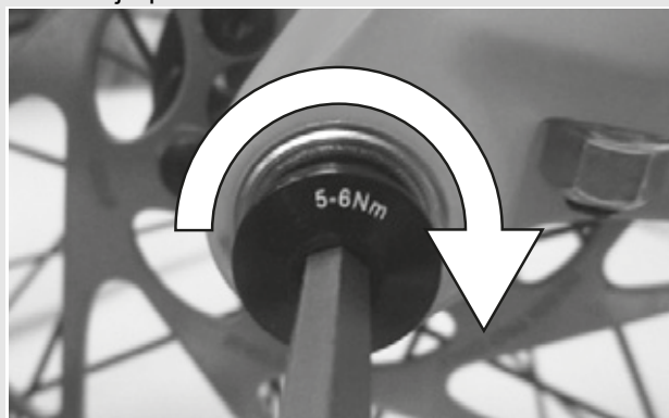
Obr. 25: Utažení pojistného šroubu
