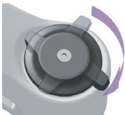
Obr. 94: Tvrdé nastavení nastavovacího šroubu komprese
