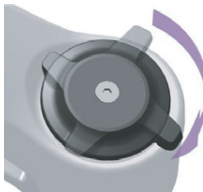
Obr. 78: Tvrdé nastavení nastavovacího šroubu komprese
