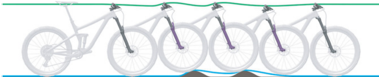
Obr. 91: Příliš pomalé roztahování odpružené vidlice
