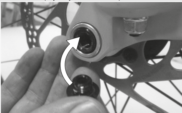
Obr. 24: Zasuňte páku rychloupínáku do osy
