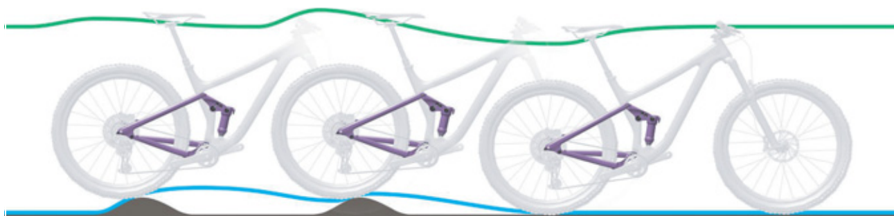
Obr. 99: Příliš pomalé roztahování tlumiče zadního odpružení
