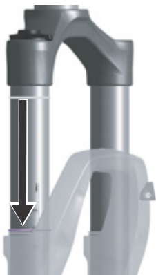
Obr. 57: Posunutí O-kroužku na odpružené vidlici
