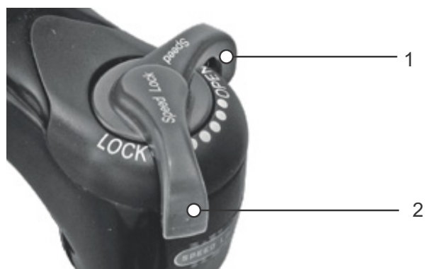
Obr. 77: Tlumič komprese Suntour v otevřené (1) a zavřené (2) poloze
