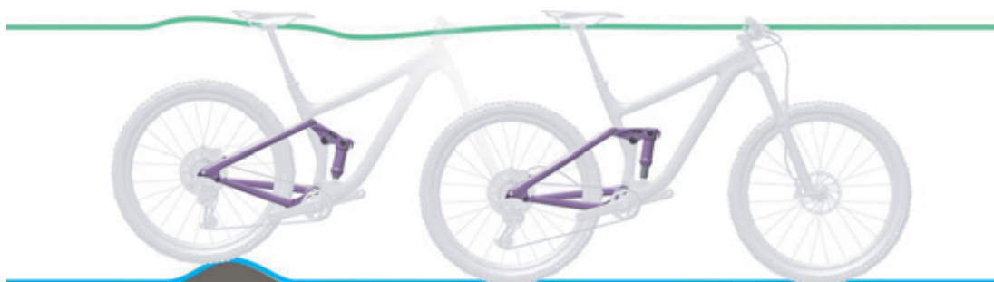
Obr. 12: Optimální chování tlumiče zadního odpružení při jízdě u nerovnosti
