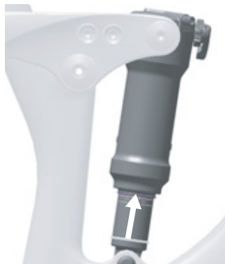
Obr. 60: Posunutí O-kroužku na tlumiči zadního odpružení
