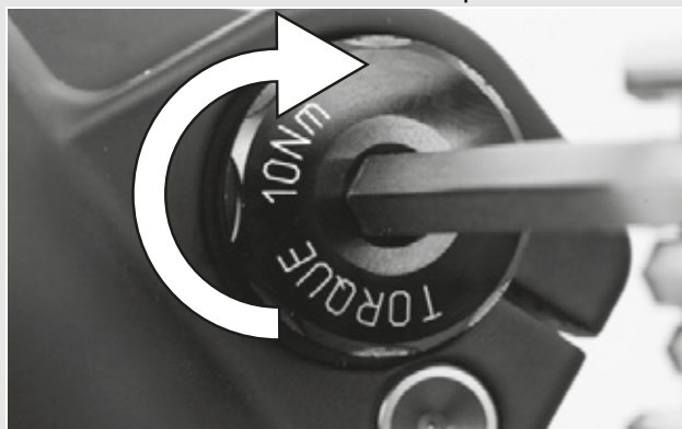
Obr. 26: Utažení zasunuté osy
